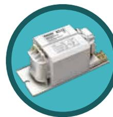
Los **balastos**, por el contrario, son dispositivos que sirven para limitar la corriente que atraviesa la lámpara, estabilizando el circuito. De lo contrario, se daría un exceso de electrones circulando por el gas que aumentaría el valor de la corriente hasta producir la destrucción de la lámpara.
